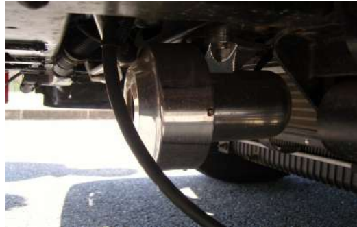
[그림 V-301] 탈착 및 배선이 빠져 있는지 확인
