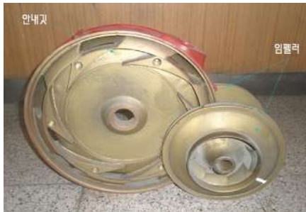
[그림 V-112] A2급 소방펌프 단면도
