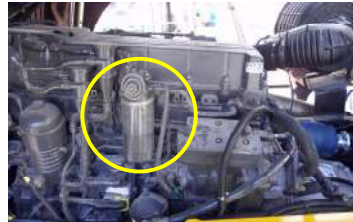
[그림 V-212] 연료 필터 및 카트리지 위치 (좌측 장착 타입)
