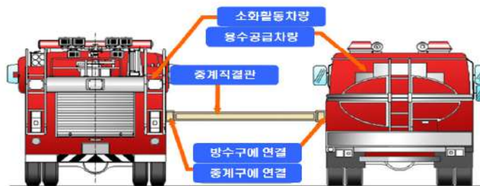
[그림 V-140] 중계관을 이용한 급수
