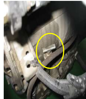
[그림 V-224] 오일 레벨 게이지 [그림 V-225] 오일 레벨 점검구 위치 [그림 V-226] 오일 레벨 점검구 위치
