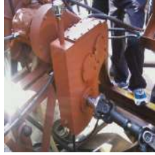
[그림 V-250] 게이지로 오일량 확인
