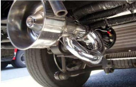
[그림 V-300] 스위치를 누른 후 작동하지 않으면 배선 탈착 및 유니트가 빠져 있는지 확인
