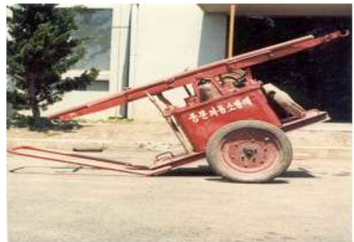
[그림 V-9] 완용펌프(중문의용소방대)
