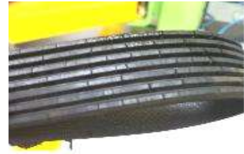
[그림 V-236] 팬벨트 안쪽 균열
