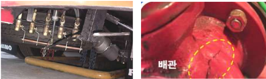
[그림 V-148] 자동배수밸브 및 배수불량으로 배관 동파
