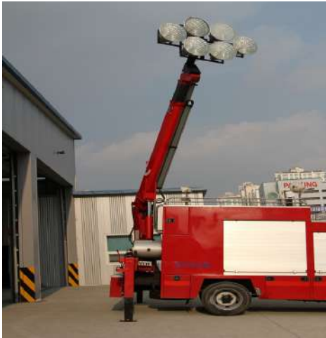
[그림 V-311] 아우트리거 작동 및 손상 여부 및 조명탑(크레인) 작동, 이음 발생 여부
