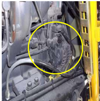
[그림 V-237] 발전기 장착 사진
