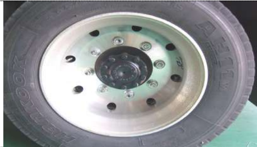
[그림 V-202] 휠 볼트 풀림 및 허브오일 누유 확인
