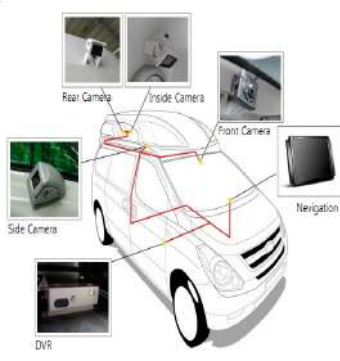
[그림 V-317] 4채널 블랙박스 (HDD, SSD 방식)
