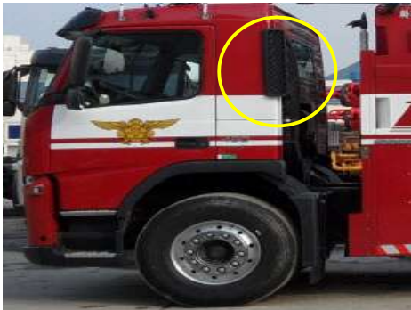
[그림 V-243] 공기흡입기 및 인테이크에어덕트
