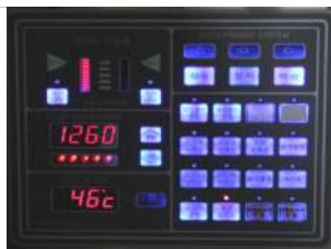
[그림 V-264] PTO 작동, 메인밸브 개방 후 RPM 상승
