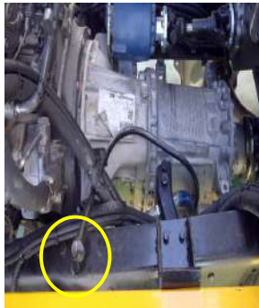
[그림 V-224] 오일 레벨 게이지 [그림 V-225] 오일 레벨 점검구 위치 [그림 V-226] 오일 레벨 점검구 위치
