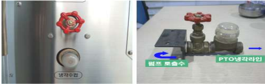
[그림 V-150] A지점, 냉각수 밸브 및 스트레이너
