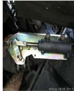
[그림 V-220] 배기브레이크 장착 상태
