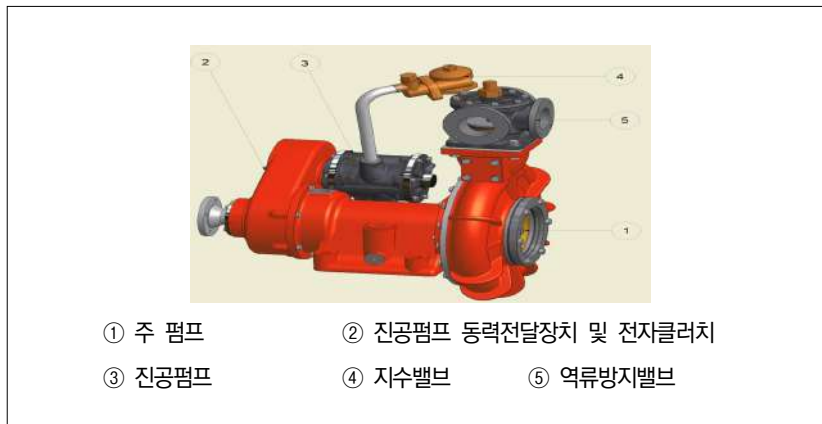
[그림 V-111] A1급 소방펌프 주변장치
