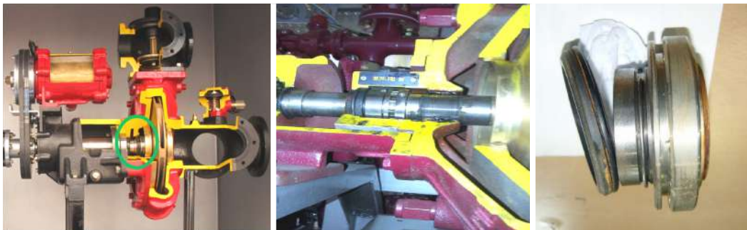
[그림 V-260] 메카니컬 씰 방식 펌프 [그림 V-261] 메카니컬 씰 분해도 [그림 V-262] 메카니컬 씰
