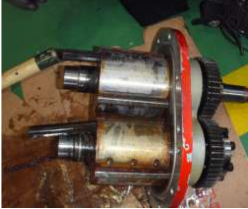
[그림 V-188] 소방펌프 임펠러 및 구동기어
