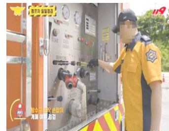
[그림 2-14] 방수구(흡수/방수)레버 개폐 확인
