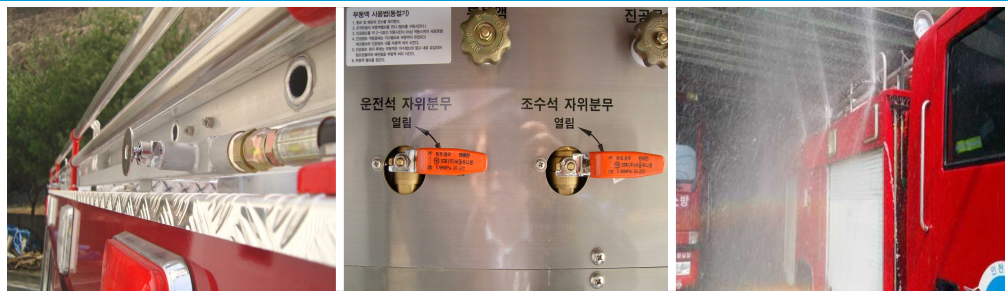
[그림 2-39] 차체분무장치 성능시험
