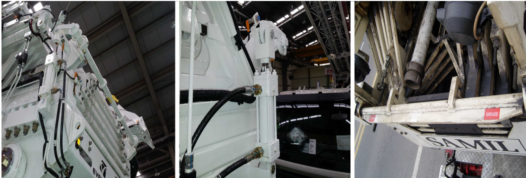
유압의 누유 및 손상여부 확인, 신장 시 해제되고 수축/안착 시 잠기는지 확인
