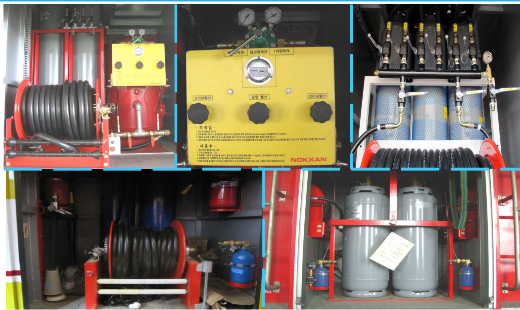
[그림 2-48] 소방화학차 분말소화장치, CO 2 소화장치, 하론소화장치
