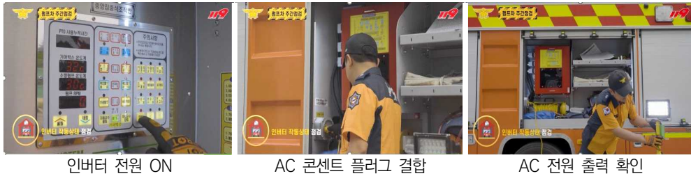
[그림 2-41] 인버터(DC▶AC 변환) 작동 확인
