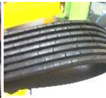
팬 벨트 안쪽 균열
