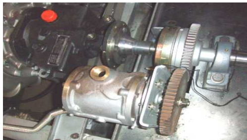
[그림 3-31] 1세대 진공펌프 롤러클러치방식(상) V벨트방식(하)
