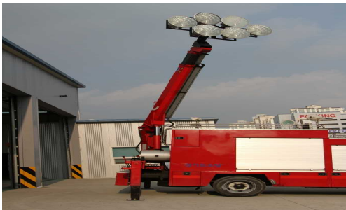
아우트리거 작동 및 손상 여부 및 조명탑(크레인) 작동, 이음 발생 여부
