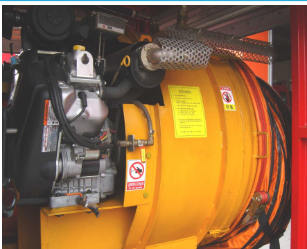
[그림 2-47] 조연차(고발포 품 주입장치) 작동 확인
