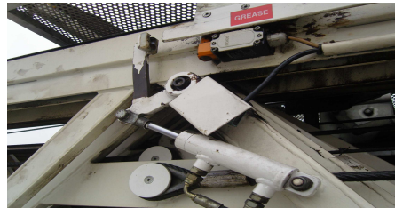
유압의 누유 및 손상여부 확인, 승강 시 해제되고 하강 완료시 자동잠김 여부 확인
