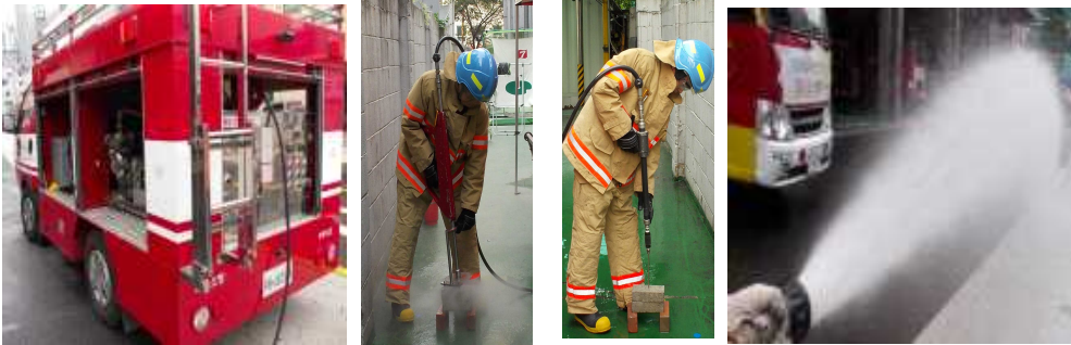
[그림 4-40] 미분무 가스소방차(좌) CO 2 주입장면(중) 미분무 방수장면(우)
