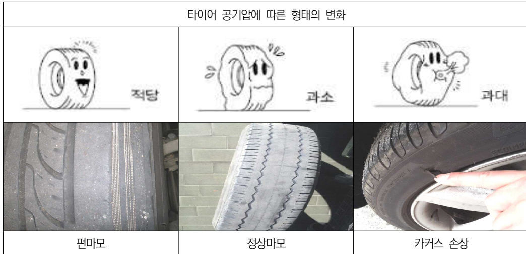
[그림 2-9] 타이어 점검요소(공기압, 외관, 마모상태)
