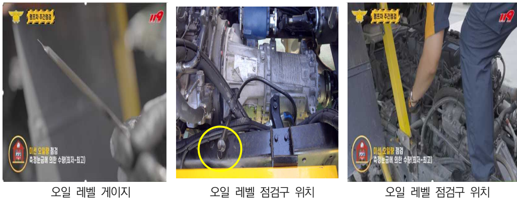
[그림 2-31] 자동변속기 오일 점검 방법
