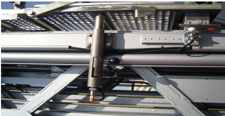
유압의 누유 및 손상여부 확인, 승강 시 해제되고 하강 완료시 자동잠김 여부 확인
