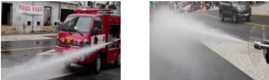
[그림 4-41] 미분무 가스소방차의 가스소화장치 작동
