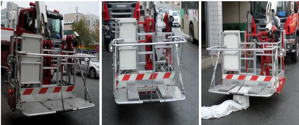
[그림 2-72] 소방 굴절차 바스켓의 수직구조대 장착대 확인
