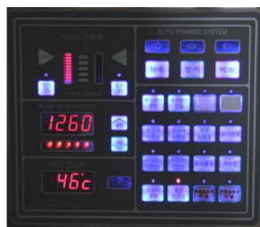
PTO 작동, 메인밸브 개방 후 RPM 상승
