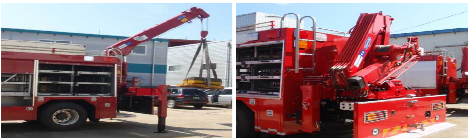
크레인 작동 상태 및 와이어 상태 및 작동상태 그리스 도포 등을 확인한다.
