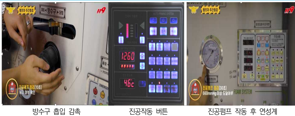
[그림 2-37] 진공펌프 동작 및 성능시험
