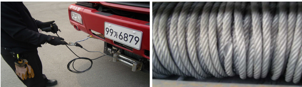
원치 작동 상태 및 와이어 감김, 손상 여부 확인한다.
