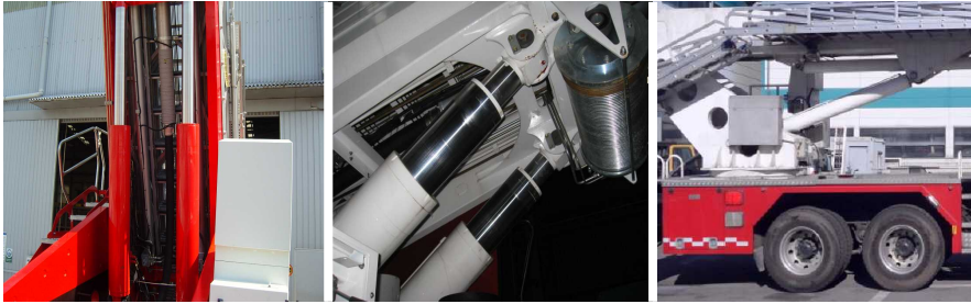
[그림 2-61] 소방 고가 · 굴절차 기복실린더 점검
