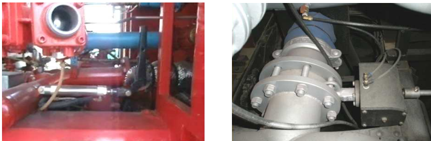
[그림 3-24] 복동형 에어실린더 및 액추에이터
