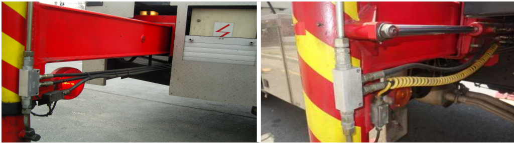
[그림 2-55] 소방 고가 · 굴절차 아우트리거
