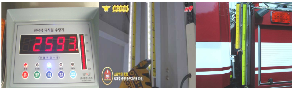
[그림 2-7] 물·폼탱크 량 확인(전자식·기계식 수량계·액량계)
