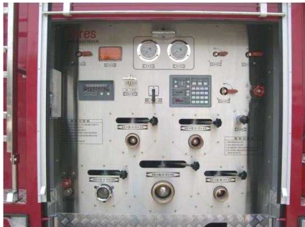
소방펌프 작동 패널(후면)
