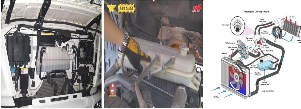
[그림 2-22] 엔진 냉각수량 점검(차종별 냉각수보조탱크 및 냉각라인 정리)
