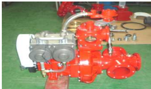
[그림 3-32] 현재 대부분 펌프차량 진공펌프 구동 및 작동방식
