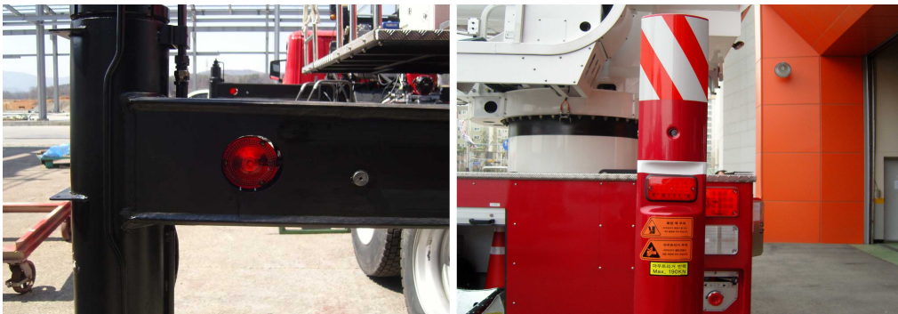
[그림 2-56] 소방 고가 · 굴절차의 아우트리거 경고등 점등 확인
