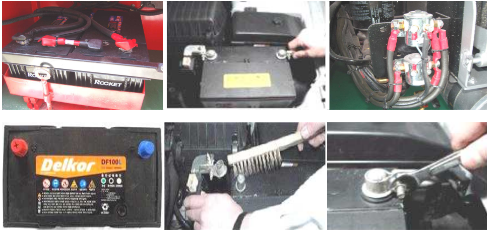
[그림 2-10] 배터리 점검 정비 요령
