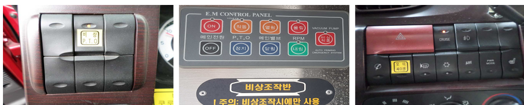
[그림 2-35] 운전석 비상PTO(좌)/ 비상조작반(펌프실)/ 크루즈버튼(우)
